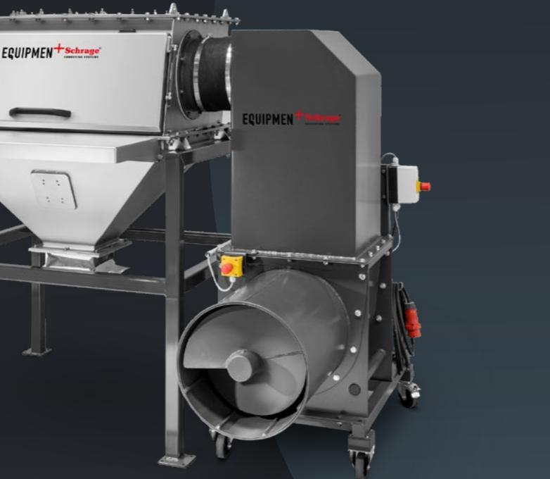
Sackentleerstation mit Leersackverdichter
