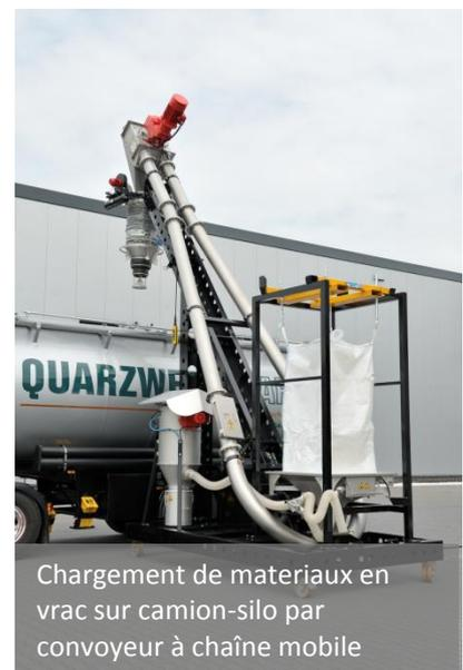
Chargement de matériaux en vrac sur camion-silo par convoyeur à chaîne mobile
