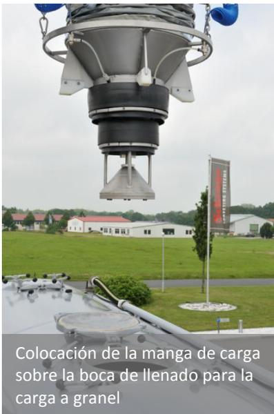
Colocación de la manga de carga sobre la boca de llenado para la carga a granel
