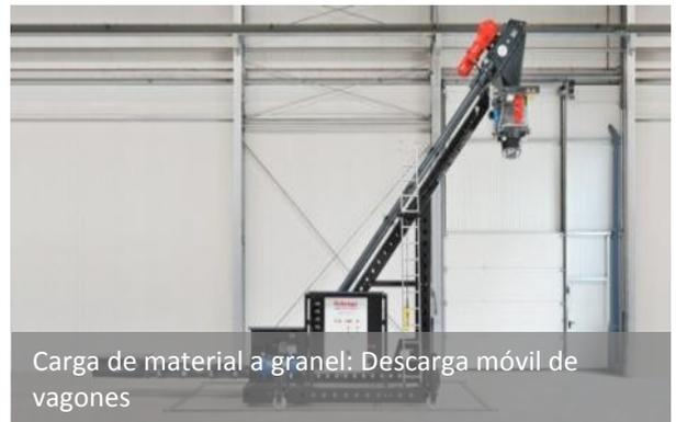
Carga de material a granel: Descarga móvil de vagones
